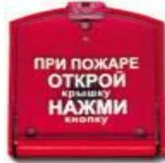
Формирование сигнала "ПОЖАР" путем нажатия защищенной кнопки с фиксацией обеспечивает возможность многократного использования прибора. В зависимости от установленного режима извещатель вырабатывает сигнал тревоги в шлейфе как посредством шунтирования линии (увеличение тока потребления до 20мА), так и размыканием "сухого" контакта. Оригинальное схемотехническое решение и использование современных сборочных технологий позволили обеспечить:
