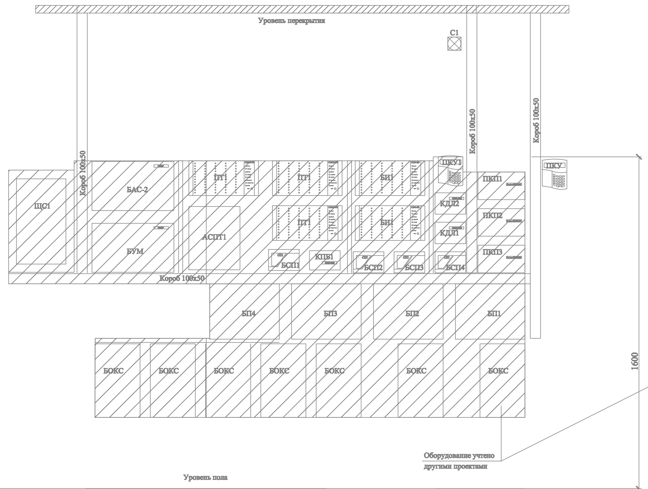
Вид-А План расположения оборудования на посту охраны
